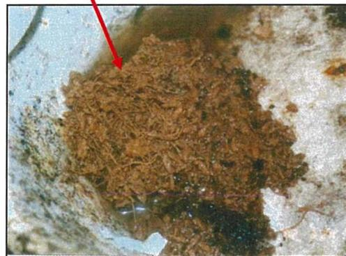
配管のスケールが、スケールウォッチャー処理効果により軟化・剥離した汚れ堆積物が多量にヘアークャッチャーのバスケット内に捕集されている。
